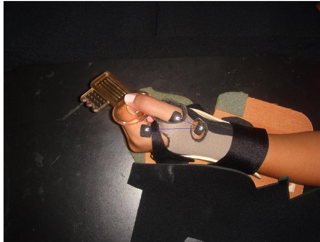
Figura 4. Resultado obtido pelo programa pela análise da fig. (2), onde as retas azuis representam o ângulo estimado.
